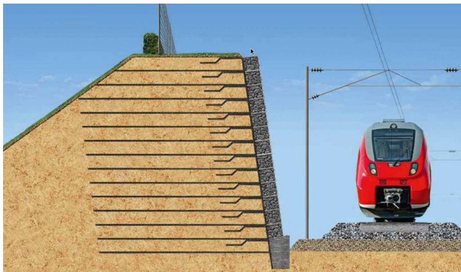
Abb. 7: Dammschüttung mit Bewehrter Erde und Gabionen als Außenhaut Quelle: Originalbilder Fa. Huesker, Internet
